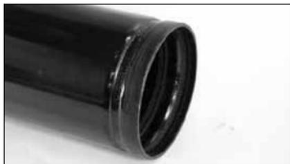
**1. CONTRÔLE DES EXTRÉMITÉS DE TUBES :** la surface extérieure des tubes, entre la rainure et l'extrémité du tube, doit être lisse et ne pas présenter de cavités ou de saillies (telles que des cordons de soudure), ni de marques de molette, pour assurer une parfaite étanchéité. Toute trace d'huile, de graisse, de peinture détachée, de saleté ou de particules de rainurage par enlèvement de métal doit être enlevée.
