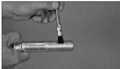
**5. LUBRIFICATION DES FILETAGES DE BOULONS :** appliquez une mince couche de lubrifiant Victaulic ou de lubrifiant base silicone sur le filetage des boulons. **REMARQUE :** si les boulons et les écrous en acier inoxydable sont commandés spécialement, appliquez un anti-grippant sur le filetage des boulons.
