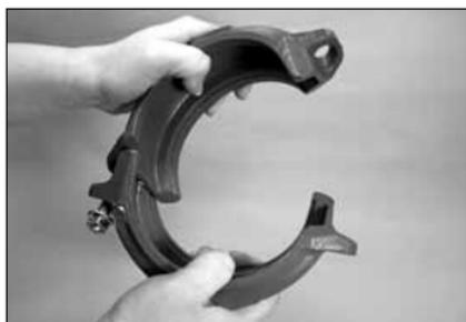
2. **ASSEMBLAGE DES SEGMENTS :** insérez un boulon dans les segments et vissez l'écrou sur le boulon, sans le serrer pour permettre l'ouverture des segments, comme indiqué ci-dessus. **REMARQUE :** l'écrou ne doit pas être dévissé plus loin que l'extrémité du boulon.
