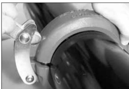
**3. POSITIONNEMENT DE LA POIGNÉE DE VERROUILLAGE :** soulevez la poignée de verrouillage pour en positionner le bec dans le creux du support prévu sur l'autre segment.
