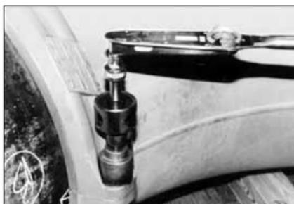
**5. SERRAGE AU COUPLE SPÉCIFIÉ :** serrez tous les écrous à 814 N•m (600 ft-lbs) au moyen d'une clé. Comme ce couple de serrage est très important, l'utilisation d'un multiplicateur de couple de serrage est conseillée.
