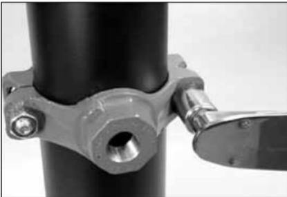
**5. SERRAGE DES ÉCROUS :** vérifiez que la collerette de positionnement soit toujours correctement positionnée dans la découpe de piquage. Serrez les écrous de manière égale et progressive en alternant les côtés jusqu'à ce que le segment supérieur (de piquage) soit entièrement en contact avec le tube.
