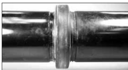
5. **ASSEMBLAGE DES TUBES OU DES ÉLÉMENTS À ASSEMBLER :** alignez les deux extrémités rainurées du tube ou de l'élément à assembler. Insérez l'autre extrémité du tube ou de l'élément à assembler dans le joint jusqu'à ce qu'elle touche la lèvre centrale du joint.
