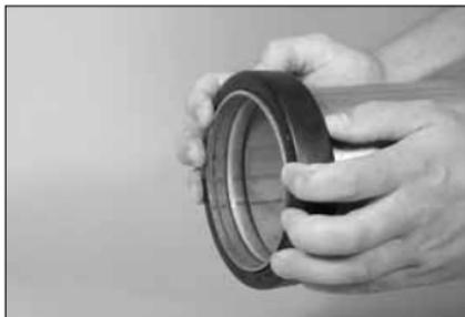
**3. MISE EN PLACE DU JOINT :** mettez le joint en place sur l'extrémité du tube. Vérifiez qu'il ne dépasse pas de l'extrémité du tube.
