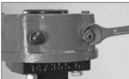
7. À l'aide d'une clé d'une taille adéquate, serrez le contre-écrou hexagonal (dans le sens horaire) situé sur le côté droit du volant réducteur.
