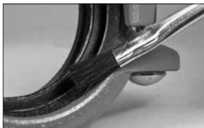
**4. LUBRIFICATION DU JOINT :** appliquez une fine couche de lubrifiant Victaulic ou de lubrifiant base silicone, uniquement sur les lèvres d'étanchéité à l'intérieur du joint. **REMARQUE :** un lubrifiant a été appliqué en usine à l'extérieur du joint ; il est donc inutile de retirer le joint des segments pour appliquer un lubrifiant supplémentaire sur la surface extérieure.
