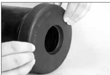
**3. INSTALLATION DU JOINT :** installez la plus grande ouverture du joint sur l'extrémité du tube de plus grand diamètre. Assurez-vous qu'aucune partie du joint ne déborde dans la rainure du tube.
