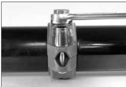
**8. SERRAGE DES ÉCROUS :** serrez les écrous de manière régulière en alternant les côtés jusqu'à ce que les surfaces métalliques des patins soient en contact. Veillez à ce que les talons des segments s'engagent complètement dans les rainures. **REMARQUE :** il est important de serrer les écrous de manière égale pour éviter de pincer le joint.
