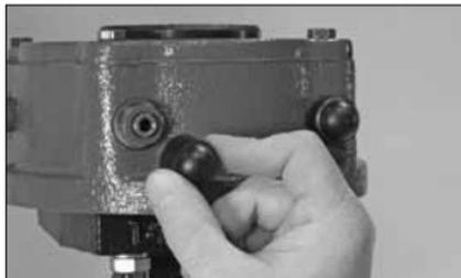
2. Retirez la protection pare-poussière des butées de déplacement à partir du côté gauche du volant réducteur de la manière représentée ci-dessus.
