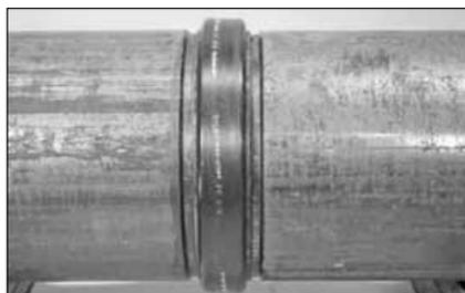
**4. JONCTION DES EXTRÉMITÉS DE TUBES :** alignez et réunissez les deux extrémités des tubes. Mettez en place le joint d'étanchéité en le faisant glisser et centrez-le dans la rainure de chaque extrémité des tubes ou du Vic-Ring AGS.
