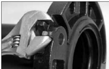
**4a. ADAPTATEURS DE BRIDE STYLE 741 OU 744 UNIQUEMENT :** l'adaptateur est pourvu de collerettes pour faciliter l'assemblage. Si nécessaire, serrez les oreilles au moyen d'une clé pour aligner les trous d'assemblage des brides et faciliter l'insertion des boulons de bride standard dans ces trous.
