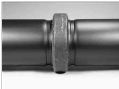
5. **ASSEMBLAGE DES TUBES OU DES ÉLÉMENTS À ASSEMBLER** : alignez les deux extrémités rainurées du tube ou de l'élément à assembler. Insérez l'autre extrémité du tube ou de l'élément à assembler dans le joint jusqu'à ce qu'elle touche la lèvre centrale du joint. **REMARQUE** : assurez-vous qu'aucune partie du joint ne déborde dans la rainure d'un des tubes/éléments à assembler.
