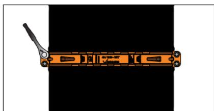
Répétez la séquence de serrage présentée ci-dessus jusqu'à ce que les impératifs d'installation de l'étape 7 soient respectés.
