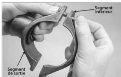
**2. ASSEMBLAGE DES SEGMENTS :** assemblez les deux segments au moyen d'un boulon. Vissez l'écrou à embase juste à l'extrémité du boulon pour permettre l'ouverture du collier.
