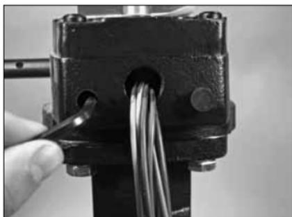
4. Une fois le disque de vanne dans la position ouverte désirée, utilisez une clé hexagonale d'une taille adéquate pour serrer (dans le sens horaire) la vis de réglage interne.
