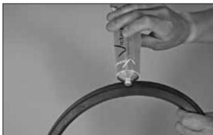
2. **CONTRÔLE ET LUBRIFICATION DU JOINT** : vérifiez que le joint convient pour l'utilisation envisagée. Le code couleur indique le grade du joint. Appliquez une mince couche de lubrifiant Victaulic ou de lubrifiant base silicone sur les lèvres intérieures et à l'extérieur du joint.
