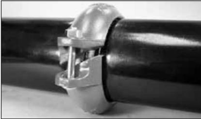
**4. POSE DU COLLIER :** mettez le collier en place en y enfonçant énergiquement de chaque côté l'extrémité rainurée des tubes/éléments à assembler, jusqu'à ce qu'elles touchent la lèvre centrale du joint. Un contrôle visuel est nécessaire pour s'assurer que les talons du collier sont bien alignés par rapport aux rainures des tubes/éléments à assembler.
