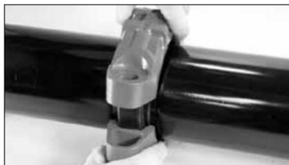
2. **MONTAGE DES SEGMENTS DE COLLIER :** mettez les segments de collier en place sur le joint. Assurez-vous que les talons des segments s'engagent complètement dans les rainures des extrémités des deux tubes.
