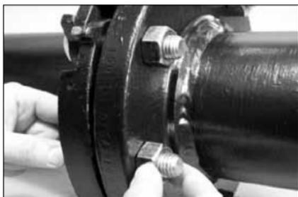
**7. MONTAGE DES BOULONS ET ÉCROUS RESTANTS :** insérez un boulon d'assemblage standard à tige non réduite dans chacun des trous restants de l'adaptateur de bride et de la contre-bride. Vissez un écrou de bride standard sur chacun de ces boulons et serrez ces écrous à fond à la main.
