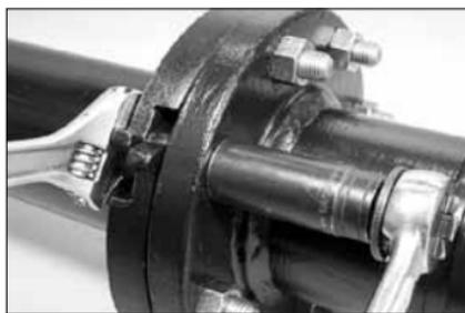
**6a.** Vissez des écrous de bride standards sur chacun des deux boulons d'assemblage et serrez ces écrous à fond à la main.
