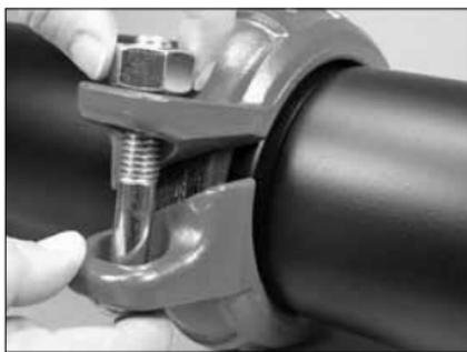
**6. POUR FACILITER LE REMONTAGE :** il est possible d'insérer un boulon dans les segments, l'écrou étant vissé sans être serré sur le boulon pour permettre l'ouverture des segments, comme indiqué ci-dessus. **REMARQUE :** l'écrou ne doit être dévissé plus loin que l'extrémité du boulon.
