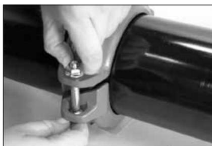
**4. INSTALLATION DU BOUTON ET DE L'ÉCROU RESTANTS :** mettez en place le boulon restant et serrez l'écrou à la main.
