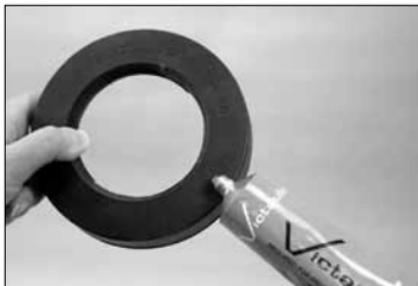
**2. CONTRÔLE ET LUBRIFICATION DU JOINT :** vérifiez que le joint convient pour l'utilisation envisagée. Appliquez une mince couche de lubrifiant Victaulic ou de lubrifiant au silicone sur les lèvres intérieures et à l'extérieur du joint.
