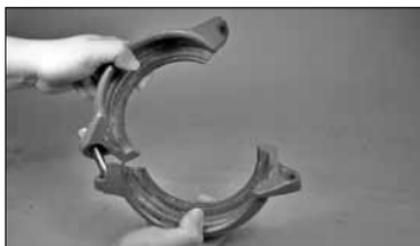
6. **POUR FACILITER LE REMONTAGE :** il est possible d'insérer un boulon dans les segments, l'écrou étant vissé sans être serré sur le boulon pour permettre l'ouverture des segments, comme indiqué ci-dessus. **REMARQUE :** l'écrou ne doit être dévissé plus loin que l'extrémité du boulon.
