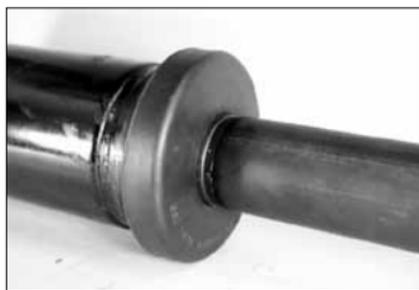
**4. ASSEMBLAGE DES EXTRÉMITÉS DE TUBES :** alignez les axes des tubes à assembler et insérez l'extrémité du tube de plus petit diamètre dans le joint. Assurez-vous qu'aucune partie du joint ne déborde dans la rainure du tube.
