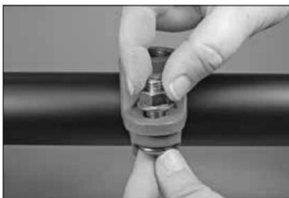
**4. MISE EN PLACE DU BOULON/ÉCROU À EMBASE RESTANT :** introduisez l'autre boulon à collet oblong dans le segment inférieur et dans le segment de sortie. Serrez l'écrou à embase manuellement sur le boulon. Assurez-vous que les boulons à collet oblong s'adaptent correctement dans les trous des boulons.
