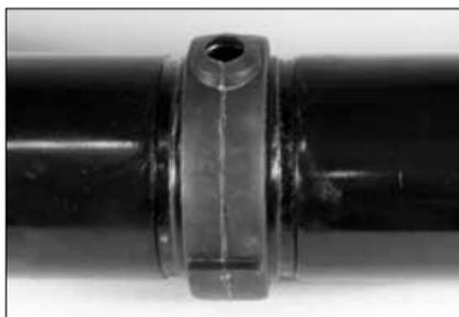
**4. ASSEMBLAGE DES EXTRÉMITÉS DE TUBES :** alignez les deux tubes face à face et rapprochez leurs extrémités. Glissez le joint en position et centrez-le entre les rainures de chaque extrémité des tubes. Assurez-vous qu'aucune partie du joint ne déborde dans la rainure d'une extrémité des tubes.
