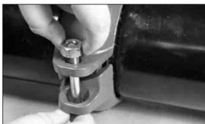
8. **INSTALLATION DU BOULON ET DE L'ÉCROU RESTANTS :** mettez en place le boulon restant et serrez l'écrou à la main. **REMARQUE :** veillez à ce que le collet ovale de chaque boulon soit bien en place dans le trou du boulon.
