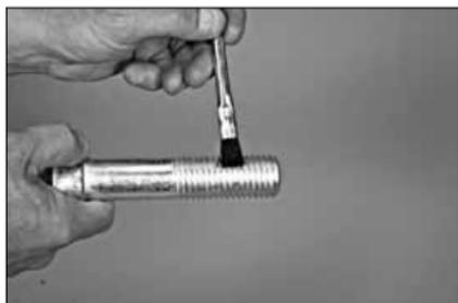
**5. LUBRIFICATION DES FILETAGES DE BOULONS :** appliquez une mince couche de lubrifiant Victaulic ou de lubrifiant base silicone sur les filetages des boulons. **REMARQUE :** si les boulons et les écrous en acier inoxydable sont commandés spécialement, appliquez un anti-grippant sur le filetage des boulons.
