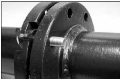
**6. ASSEMBLAGE DE L'ADAPTATEUR DE BRIDE À LA CONTRE-BRIDE :** assemblez l'adaptateur de bride à la contre-bride en alignant les trous.
