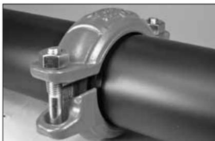
**5. POSE DU COLLIER :** mettez le collier en place en y enfonçant énergiquement de chaque côté l'extrémité rainurée des tubes/éléments à assembler, jusqu'à ce qu'elles touchent la lèvre centrale du joint. Un contrôle visuel est nécessaire pour s'assurer que les talons du collier sont bien alignés par rapport aux rainures des tubes/éléments à assembler. **REMARQUE :** il est possible de tourner le collier pour garantir le positionnement correct du joint.
