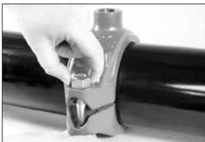
**7. INSTALLATION DES BOULONS ET ÉCROUS :** insérez les boulons dans les patins puis vissez un écrou sur chaque boulon et serrez-les à la main. **REMARQUE :** veillez à ce que le collet ovale de chaque boulon soit bien en place dans le trou de boulon.
