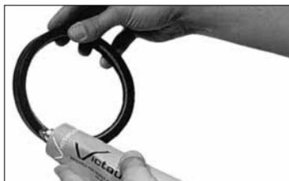
**2. CONTRÔLE ET LUBRIFICATION DU JOINT** : vérifiez que le joint convient pour l'utilisation envisagée. Appliquez une mince couche de lubrifiant Victaulic ou de lubrifiant au silicone sur les lèvres d'étanchéité intérieures et à l'extérieur du joint.
