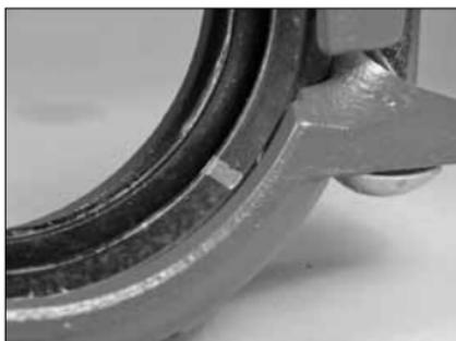
3. **CONTRÔLE DU JOINT :** vérifiez que le joint convient pour l'utilisation envisagée. La nature du joint est identifiée par un code couleur. Consultez la section « Sélection des joints » de ce manuel pour prendre connaissance du tableau des codes couleur.
