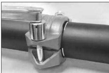
**8. SERRAGE DES ÉCROUS :** serrez tous les écrous, de manière égale et progressive, en alternant les côtés, au couple de serrage spécifié dans le tableau « Couple de serrage du Style 99 » ci-dessous. **L'utilisation d'une clé est vivement conseillée pour un montage correct des colliers Roust-A-Bout Style 99. REMARQUE :** il est important de serrer les écrous de manière égale pour éviter de pincer le joint et de faire apparaître des écarts entre les patins égaux sur les deux côtés du collier.
