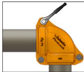
**7. SERRER COMPLÈTEMENT LE PREMIER ÉCROU EXTÉRIEUR :** serrer complètement le premier écrou extérieur en veillant à ce que les surfaces métalliques des patins se touchent. S'assurer que les talons du raccord s'insèrent complètement dans la rainure et que le collet oblong est bien logé dans le trou de boulon.
