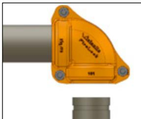
**5. INSÉRER LA SECONDE EXTRÉMITÉ DE L'ÉLÉMENT À ASSEMBLER :** insérer la deuxième extrémité rainurée de l'élément à assembler dans l'autre ouverture du raccord jusqu'à ce qu'il y ait contact avec la butée de tube du joint. Il faut contrôler visuellement que les talons du raccord sont alignés avec la rainure de l'extrémité de l'élément à assembler.
