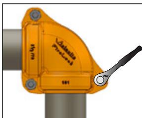
**6. SERRER COMPLÈTEMENT LE SECOND ÉCROU EXTÉRIEUR :** serrer complètement le second écrou extérieur jusqu'à ce que les surfaces métalliques des patins se touchent. S'assurer que les talons du raccord s'insèrent complètement dans la rainure et que le collet oblong est bien logé dans le trou de boulon.
