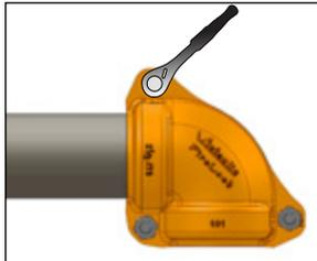
**4a. SERRER L'ÉCROU EXTÉRIEUR :** serrer l'écrou extérieur jusqu'à ce que les surfaces métalliques des patins se touchent. S'assurer que les talons du raccord s'insèrent complètement dans la rainure et que le collet oblong est bien logé dans le trou de boulon.
