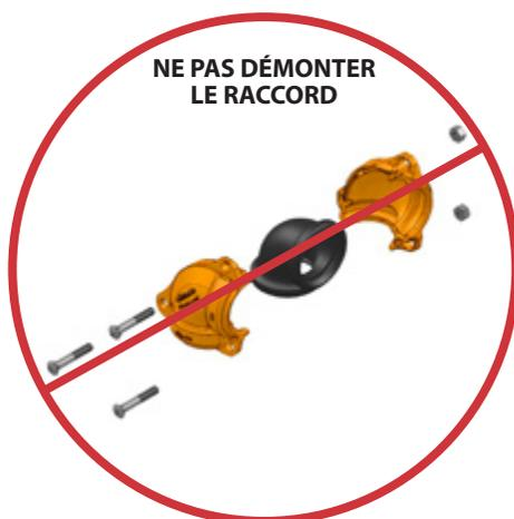
**1. NE PAS DÉMONTÉ LE RACCORD :** les raccords Victaulic® FireLock™ Installation-Ready™ n°s 101 et 103 sont conçus de sorte que l'installateur n'ait pas à déposer les écrous et boulons pour les monter. Cette conception facilite le montage car l'installateur peut insérer directement l'extrémité rainurée des éléments à assembler dans le raccord.
