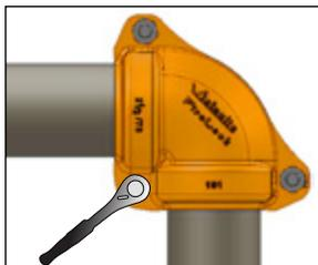
**5a. SERRER COMPLÈTEMENT L'ÉCROU INTÉRIEUR :** serrer complètement l'écrou intérieur jusqu'à ce que les surfaces métalliques des patins se touchent. S'assurer que les talons du raccord s'insèrent complètement dans la rainure et que le collet oblong est bien logé dans le trou de boulon.
