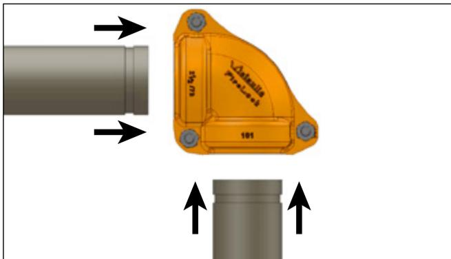
1. Pour des raisons de commodité, il est possible d'insérer toutes les extrémités rainurées des éléments à assembler dans le raccord avant le serrage. Dans ce cas, la boulonnerie doit être serrée uniformément en alternant les côtés jusqu'à ce que les exigences d'installation figurant dans les présentes instructions soient satisfaites.
