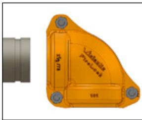
**4. INSÉRER LA PREMIÈRE EXTRÉMITÉ DE L'ÉLÉMENT À ASSEMBLER :** réaliser l'assemblage en insérant l'extrémité rainurée de l'élément à assembler dans une ouverture du raccord jusqu'à ce qu'il y ait contact avec la butée de tube du joint. Il faut contrôler visuellement que les talons du raccord sont alignés avec la rainure de l'extrémité de l'élément à assembler.
