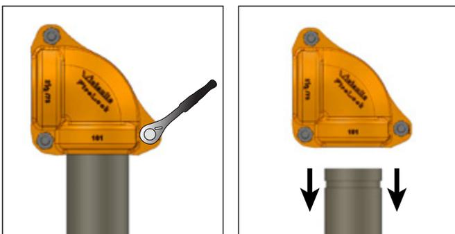
3. Tout en tenant le raccord, desserrer l'autre écrou extérieur. Retirer soigneusement le raccord de l'élément à assembler.
