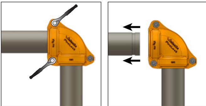
2. Ne desserrer que les écrous extérieurs et intérieurs de l'extrémité du raccord d'où le premier élément à assembler doit être retiré. Retirer l'élément à assembler du côté desserré. S'assurer que le raccord soit bien attaché à l'autre élément à assembler pour éviter une chute du raccord.
