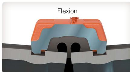
**Flexibilité** – avec les propriétés de déplacement axial et de flexion des accouplements flexibles d'un système à rainures. Peuvent être utilisés pour accommoder les dilatations et contractions thermiques des pipelines et procurent une souplesse d'ajustement d'alignement et d'affaissement du sol ou de stress sismique.
